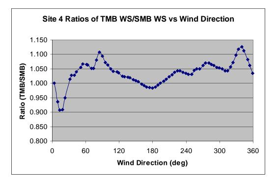
FIGURE 4. SMOOTHED RATIOS (TMB/SMB) OF WIND SPEED VERSUS WIND DIRECTION AT SITE 4.
